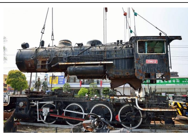
写真2 車体を分解して吊上げた例
