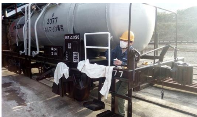
▲手すり部分に白入れ中の様子
