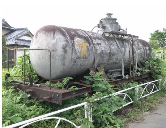
▲南側より。こちら側の連結器が欠損
